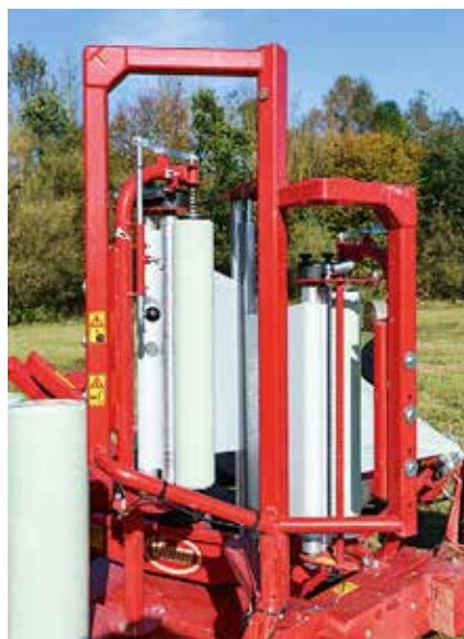
Zwei von links gut zugängliche Vorstreckereinheiten halbieren die Wickelzeit.
