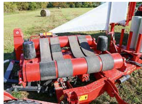
Der Wickeltisch besteht aus vier Bändern, die Führungstöpfe sind verstellbar.
