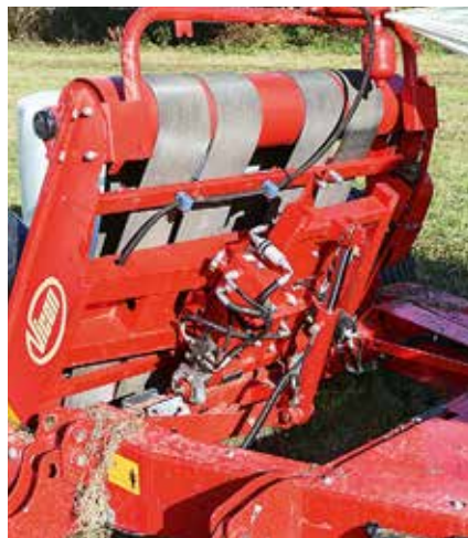
Hydraulik, Elektronik und Sensorik sitzen geschützt unter dem Tisch.
