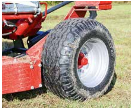
Eine ordentliche Bereifung und Kontergewichte auf der linken Seite erlauben das Aufnehmen des nächsten Ballens noch beim Wickeln.
